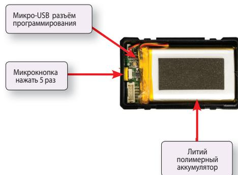
Для включения устройства необходимо при подключенных батареях 5 раз подряд быстро нажать кнопку SOS. В включённом состоянии светодиод каждые 5 секунд коротко вспыхивает красным светом. Когда маяк включен – такие же вспышки в спящем режиме, но синего цвета.
